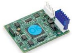
Der EZ-Compass 3A liefert kontinuierlich Daten über Ausrichtung, Feld, Neigung und Temperatur per Standard RS-232 und RS-422 Schnittstellen.
