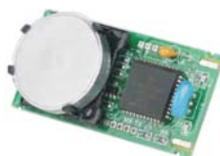
Die Isu-Inklinometer ermöglichen eine einfache und kostengünstige Integration eines 360° Winkelmessbereiches in die Applikation.
