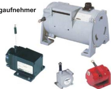
Celescoss Seilzugwegaufnehmer erfassen und messen lineare Positionen und Geschwindigkeit mit Hilfe eines flexiblen Seiles auf einer federgespannten Trommel.
